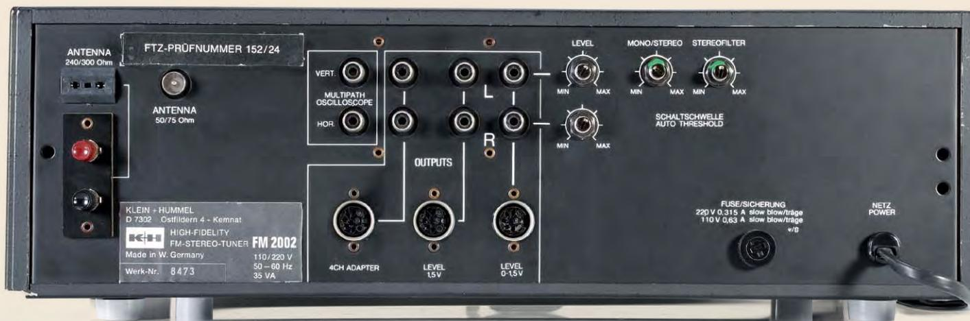
Überraschungen und Spieltrieb: Gleich drei unterschiedliche Antennenquellen lässt der FM 2002 zu – von der DIN-Buchse bis zum Flachkabel (links). Die Schaltschwellen für Stereo-Filter sowie für die automatische Mono-Umschaltung sind individuell justierbar (oben rechts), ebenso der Output eines Ausgangs. Die ganz große Kür: ein Quadrofonie-Ausgang (halb links, unten) plus ein Oszilloskop-Dock (halb links, oben).
