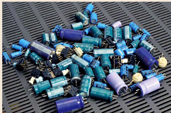
Platz da: Eine gute Handvoll Bausteine wird bei der Profi-Überholung getauscht – Druckschalter, Widerstände, Kondensatoren. Die rund fünfzig Originale werden dem überholten PM-665 beigelegt.
