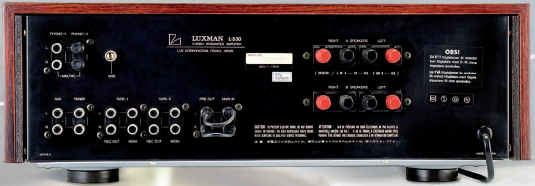
Der Rücken kündigt von der einstigen Übermacht des „Phono“ – mit doppeltem, vergoldeten Eingang links oben (und einer superben Phonostufe dahinter). Die Boxenklemmen wollen rohe Strippen zugefüttert bekommen. Tuning-Option: die kargen Cinch-Strippen zwischen Vor- und Endstufe (links unten).
