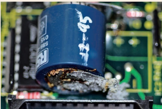
Schwache Bauteile kann man vielleicht akzeptieren – doch kritisch wird das Alter in diesem Punkt: Im unverbauten Urmodell unseres C-280 war der Speicherakku ausgelaufen.
